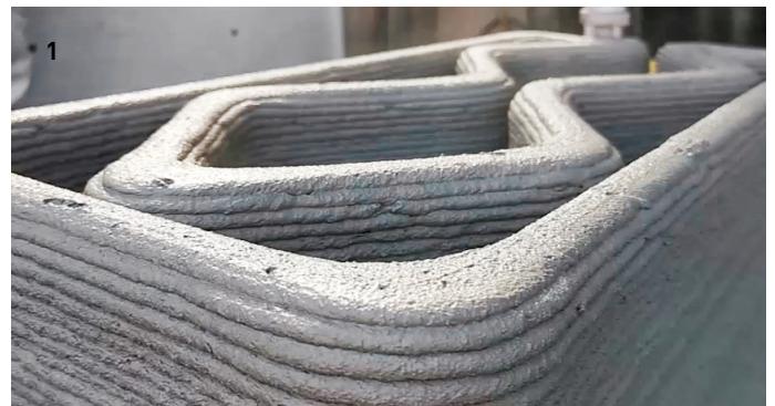
1 Darstellung der Leichtbaustruktur
