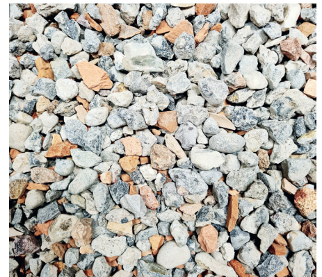
Bauwerkssplitt / RC-Gesteinskörnung Typ 2
