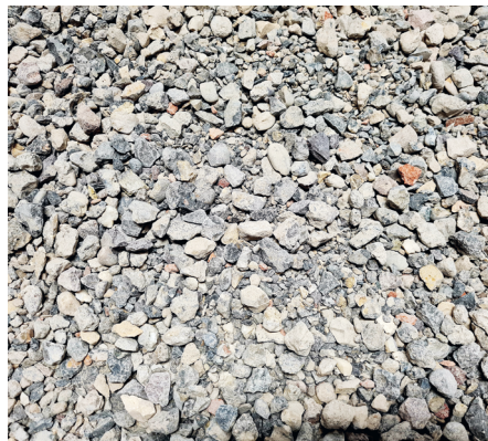
Betonsplitt / RC-Gesteinskörnung Typ 1
