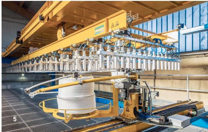
4 Der Schalungsroboter bringt die Schalung millimetergenau dort auf dem Tisch an, wo sie im Plan eingezeichnet ist. /
