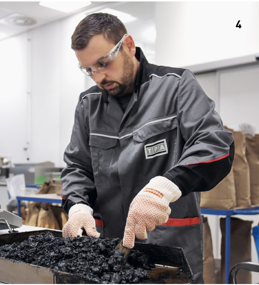
4 Im Labor wird das Mischgut mit Recyclingasphalt auf Herz und Nieren geprüft. © Sebastian Sieberer
