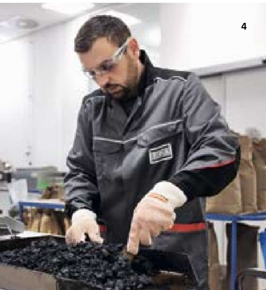
4 Amestecul cu asfalt reciclat este pus la încercare în laborator. © Sebastian Sieberer
